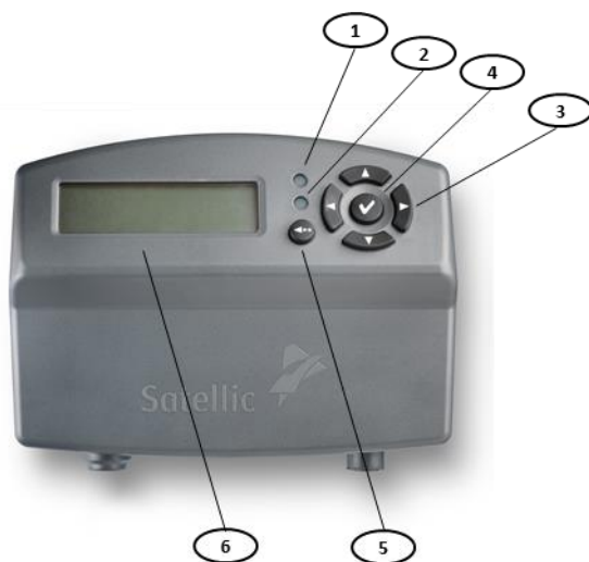
Illustration 1 : Système de commande général de l'OBU
