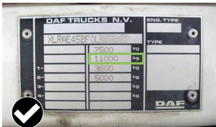
Cette plaque présente les mêmes dimensions dans toute l'Europe. En général, elle comporte deux colonnes comportant les masses (toujours utiliser la colonne de droite). La seconde ligne est la valeur à droite au-dessus de la charge par essieu et comporte toujours la MMAT.
