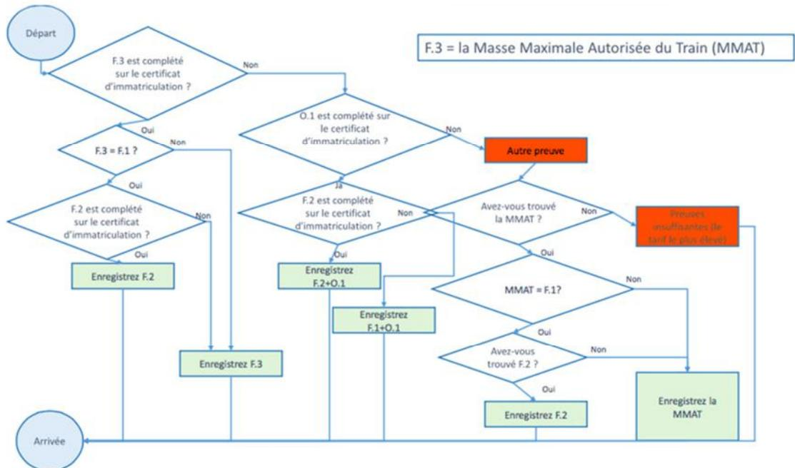
Figure 1: Diagramme expliquant comment déterminer la valeur à encoder dans le système.
