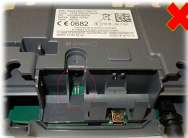
Gebroken of Ontbrekende Koppeling
