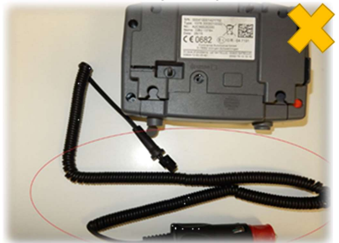
Niet Originele Voedingskabel
