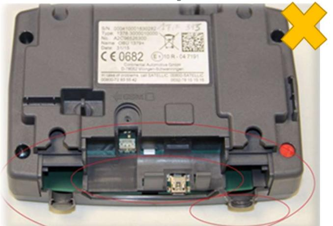
Fehlendes Kabel und/oder Batteriefachdeckel
