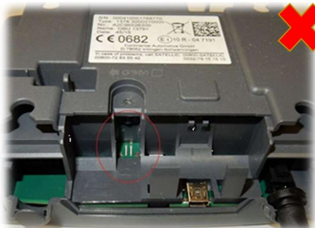
Gebrochene oder fehlende Steckverbindung
